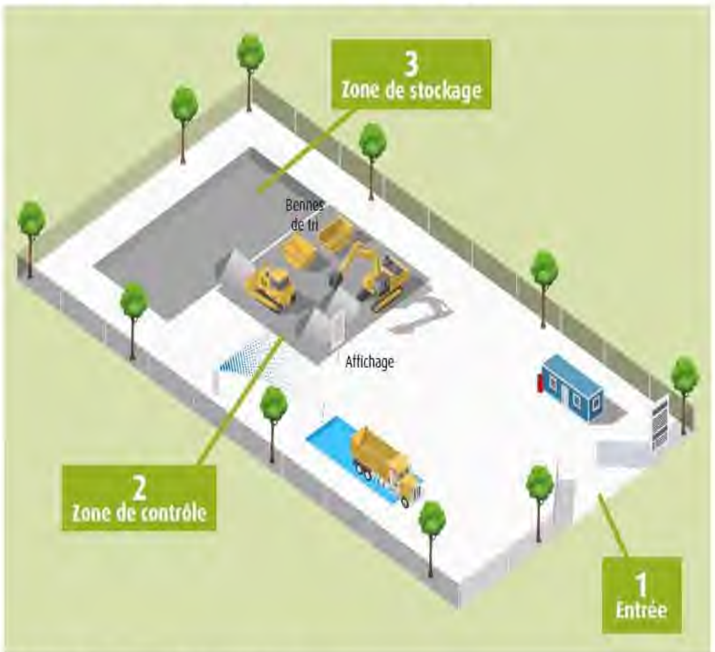
Illustration 5 - Cheminement des déchets sur l'ISDI.
